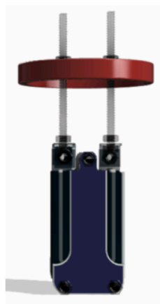
Figura 8. Definición de distancia entre varillas y realización de agujeros.
