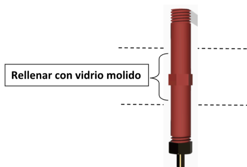
Figura 17 - Segunda parte rellenar con vidrio molido
