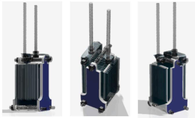
Figura 7. Diferentes perfiles del sándwich armado con las varillas exteriores incluidas.
