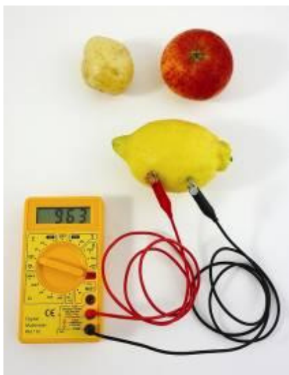
Fig. 1.1: la medición de la tensión en una pila de fruta.
