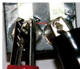
Fig. 20: distancia segura : las pinzas cocodrilo no se pueden tocar, incluso si se mueven los cables.
