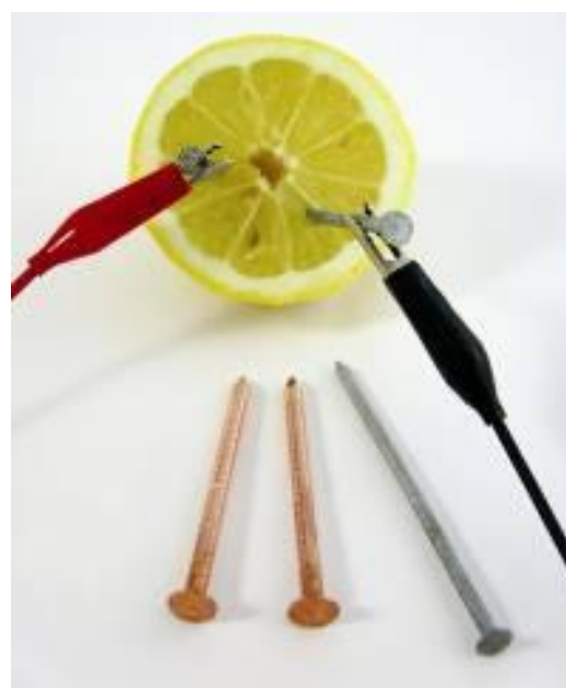
Fig. 1.5: la medición de diferentes combinaciones de metales.
