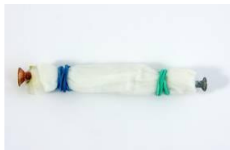
Fig. 1.10: el paquete de electrodos listo, mojado con la solución de salmuera.
