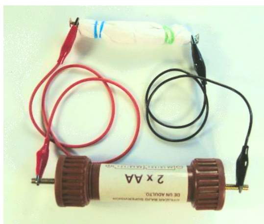
Fig. 1.12: cómo cargar el paquete de electrodos (hay distintos modelos de portapilas, la imagen es solo ilustrativa).
