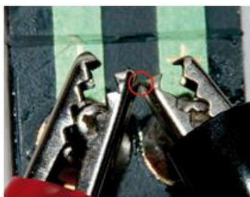
Fig. 19: las pinzas cocodrilo se tocan, por lo que se produce un cortocircuito .
