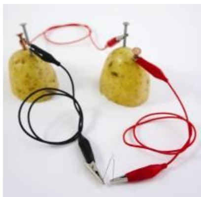
Fig. 1.3: el LED en dos pilas de verdura conectadas en serie.
