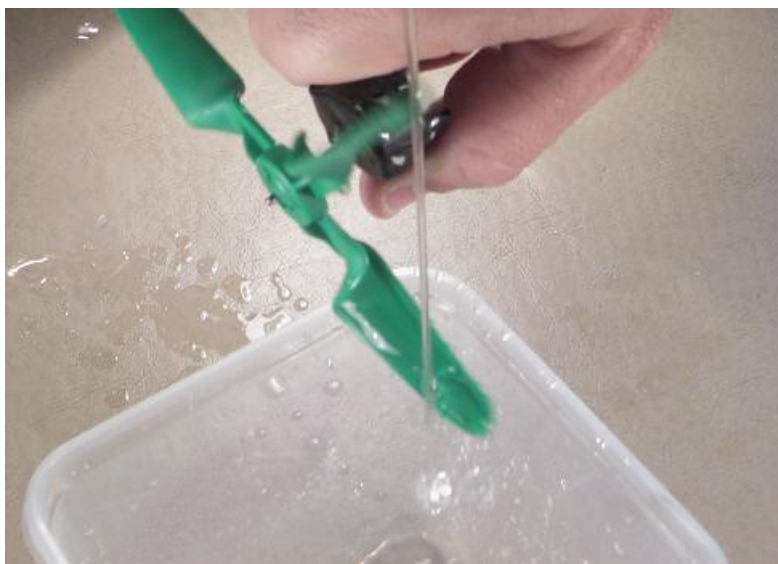
Fig. 3.10: el molino de agua se mueve debajo del chorro de agua.
