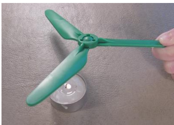
Fig. 3.8: cómo doblar las aspas de la hélice con calor.
